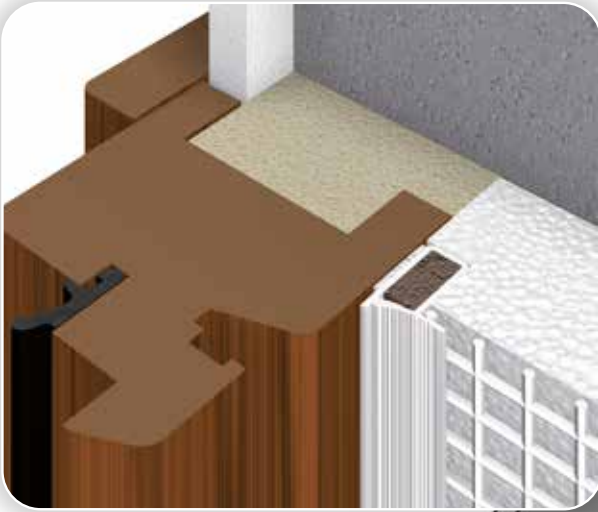
Detalle del perfil de PVC para puertas y ventanas
